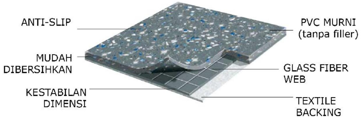
1. **PVC MURNI** dengan agregat anti slip (Tingkat Anti Slip: **R10**) merupakan *satu lapisan adonan* keseluruhan, dan *bukan corak desain yang dicetak di atasnya*.
